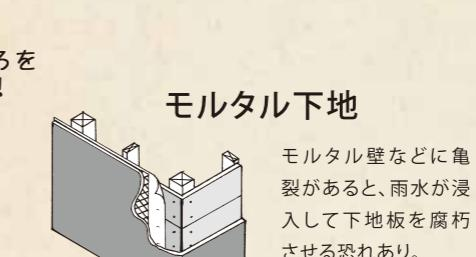
モルタル壁などに亀裂があると、雨水が浸入して下地板を腐朽させる恐れあり。
